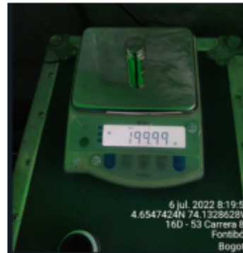
Fotografía 8. Verificación balanza (masa de 200 g).
