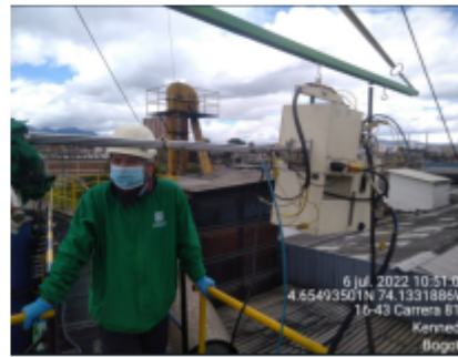
Fotografía 6. Operación en chimenea tren de muestreo
